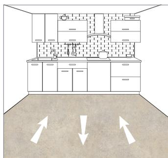
Pour la plupart des motifs, les feuilles alternées doivent être installées dans des directions opposées. Vérifiez les spécifications du modèle avant de commencer.
